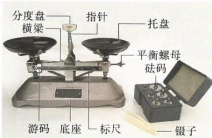
(a) 托盘天平的结构示意图
